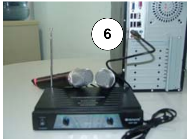
Gambar 15. Sambungan Microphone Wireless ke Komputer PC
