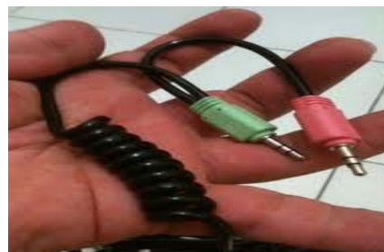
Gambar 6. Konektor Audio Jek Mic (Merah) dan Jek Speaker (Hijau)
