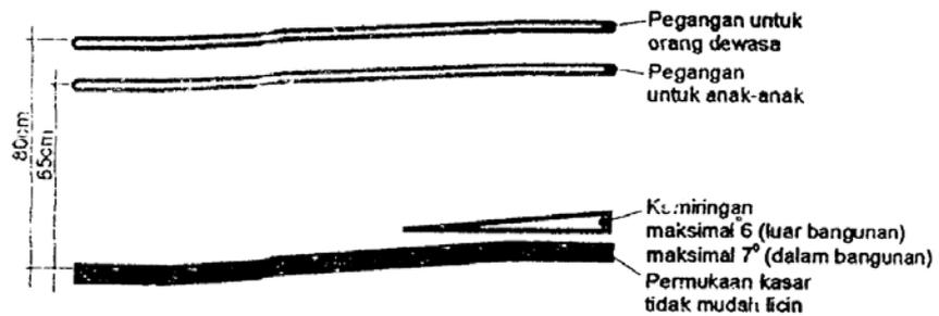
Gambar 5.11.1.d – Pegangan rambat pada ramp.
